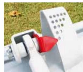
**REGLAGE HYDRAULIQUE DE LA HAUTEUR DE COUPE**
