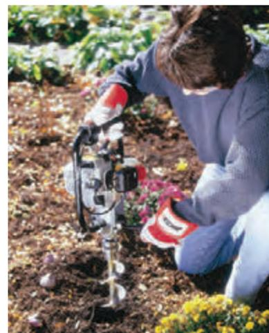
La chignole thermique **ECHO EDR-2400** est équipée d'une poignée enveloppante pour faciliter la tenue de l'appareil : on y trouve l'interrupteur et l'accélérateur.
